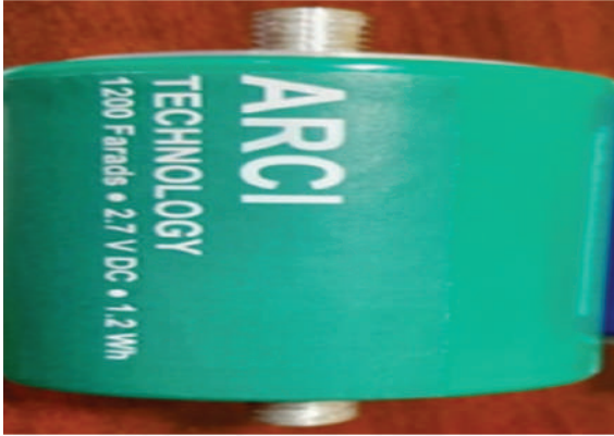
पेट्रोलियम कोक कचरे से उत्पन्न सक्रिय कार्बन का उपयोग कर स्वदेशी रूप से विकसित 1200एफ सुपरकैपेसिटर
