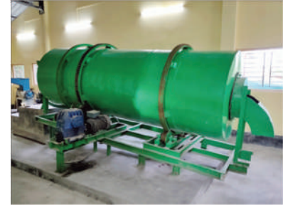
चित्र. आई आई टी गुवाहाटी में स्थापित सतत रोटरी ड्रम कंपोस्टर (आर डी सी) की छवि
