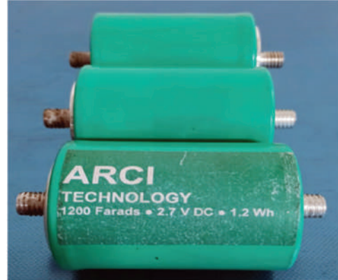
पेट्रोलियम कोक कचरे से उत्पन्न सक्रिय कार्बन का उपयोग कर स्वदेशी रूप से विकसित 1200एफ सुपरकैपेसिटर
