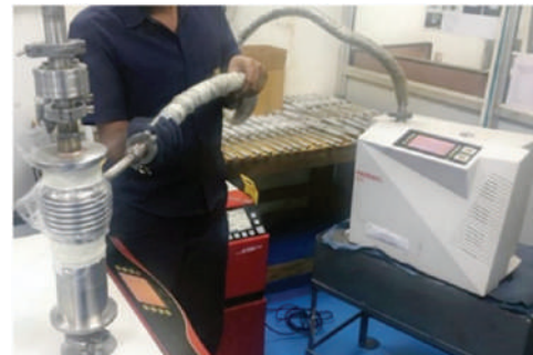
चित्र. प्रगति में धातु बेलो विस्तार जोड़ों का निर्माण (धातु बेलो, चेन्नई) प्रोटोटाइप मेटल बेलो (बाएँ), प्रगति में धातु बेलो विस्तार संयुक्त का रिसाव परीक्षण (दाएँ)
