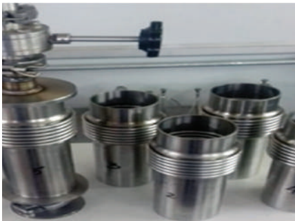
चित्र. प्रगति में धातु बेलो विस्तार जोड़ों का निर्माण (धातु बेलो, चेन्नई) प्रोटोटाइप मेटल बेलो (बाएँ), प्रगति में धातु बेलो विस्तार संयुक्त का रिसाव परीक्षण (दाएँ)
