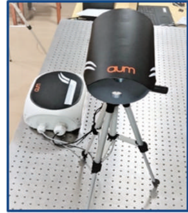
चित्र. वायु अद्वितीय गुणवत्ता निगरानी (ए यू एम) के लिए फोटोनिक प्रणाली।
