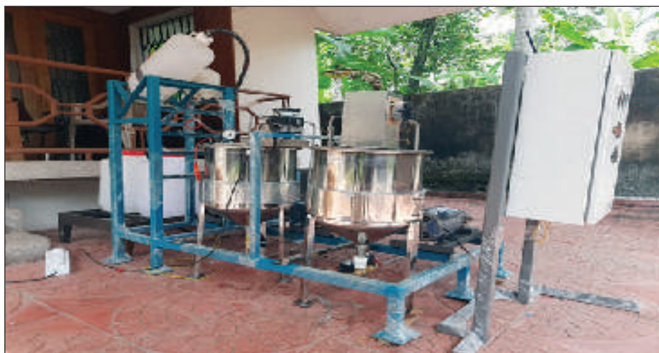
चित्र पीसी-एससीटीआईएमएसटी-टीआईएमईडी- (Sreechitra टिरूनल इन्स्टीट्यूट त्रिवेन्द्रम) द्वारा उपयोग किये गये खाना पकाने के पुनः प्रयोजन के लिये वायोकैटालिक प्रणाली के लिये विकसित प्रोटोटाइप
