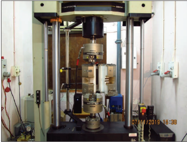
मेटालर्जिकल एंड मैटेरियल इंजीनियरिंग, जादवपुर विश्वविद्यालय, कोलकाता में डीएसटी / फिस्ट के तहत अधिग्रहीत फर्नेस के साथ इलेक्ट्रिक यूनिवर्सल टेस्टिंग मशीन
