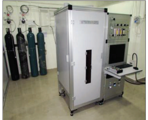
अन्ना यूनिवर्सिटी चेन्नई में डीएसटी फिस्ट के तहत हासिल किए गए चार दर्पण ऑप्टिकल फ्लोटिंग जोन क्रिस्टलल ग्रोथ सिस्टम
