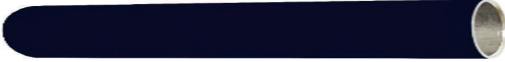
चित्र 8. एन ए एल में उच्च तापमान वाले सौर तापीय अनुप्रयोग के लिए स्पटर डिपोजिटेड कोटिंग्स
