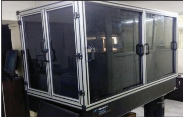
(ए) आईआईटीएम में संलग्न के साथ माइक्रो-मैकिंग वर्कस्टेशन का पूरा सेटअप और (बी) आईडीएस कैमरा के साथ कार्य क्षेत्र के अंदर का दृश्य
